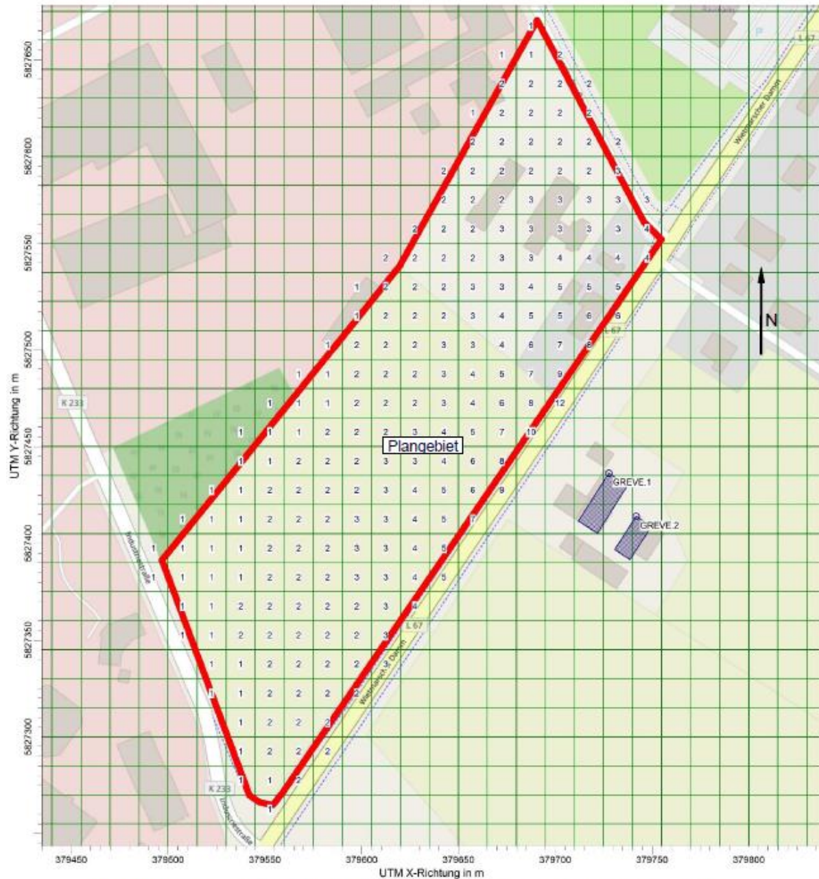
Abbildung 4: belästigungsrelevante Kenngrößen der Gesamtbelastung IG_b nach Anhang 7 der TA Luft /1/ durch landwirtschaftliche Betriebe in Prozent der Jahresstunden im Plangebiet. Zur Bestimmung der Kenngrößen als relative Häufigkeiten müssen die Werte in der Abbildung mit dem Faktor 0,01 multipliziert werden.
