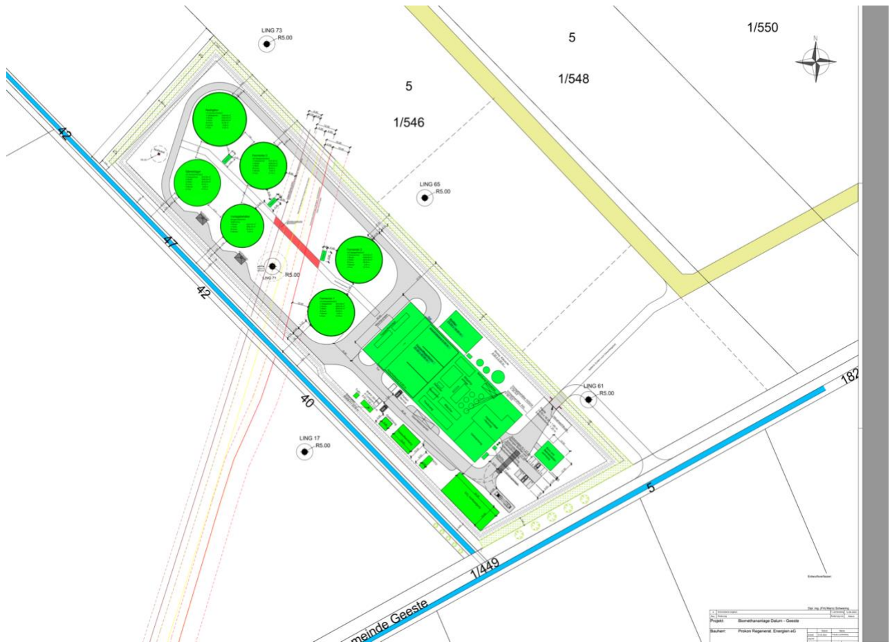
Bild 1: Lageplan der Biogasanlage
