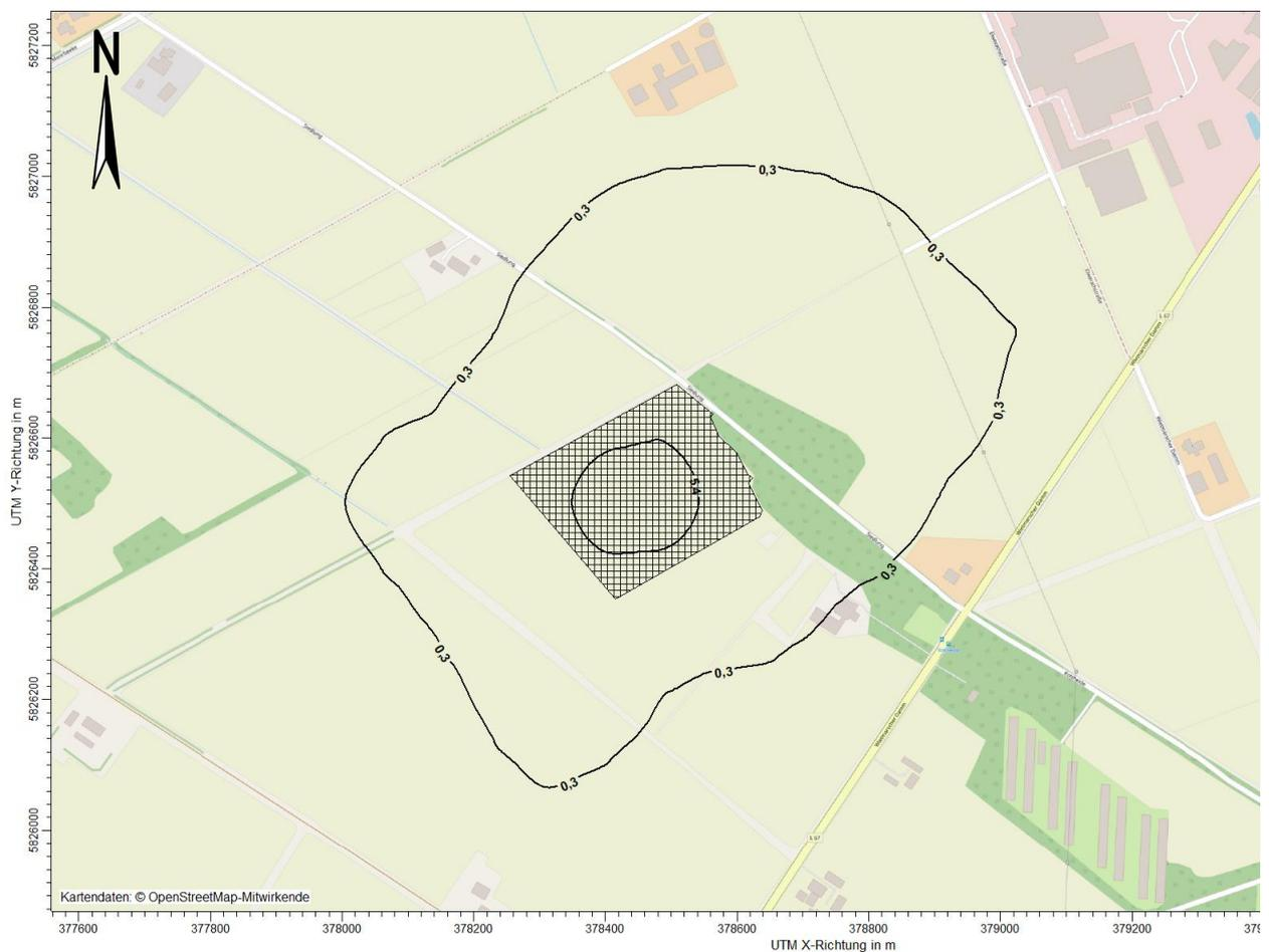
Abbildung 6: Stickstoffdeposition: Gesamtzusatzbelastung durch den geplanten Legehennenstall in  $\text{kg}/(\text{ha} \times \text{a})$ ,  $n(\text{meso})\text{-dep}$  (gültig für Mesoskala)
