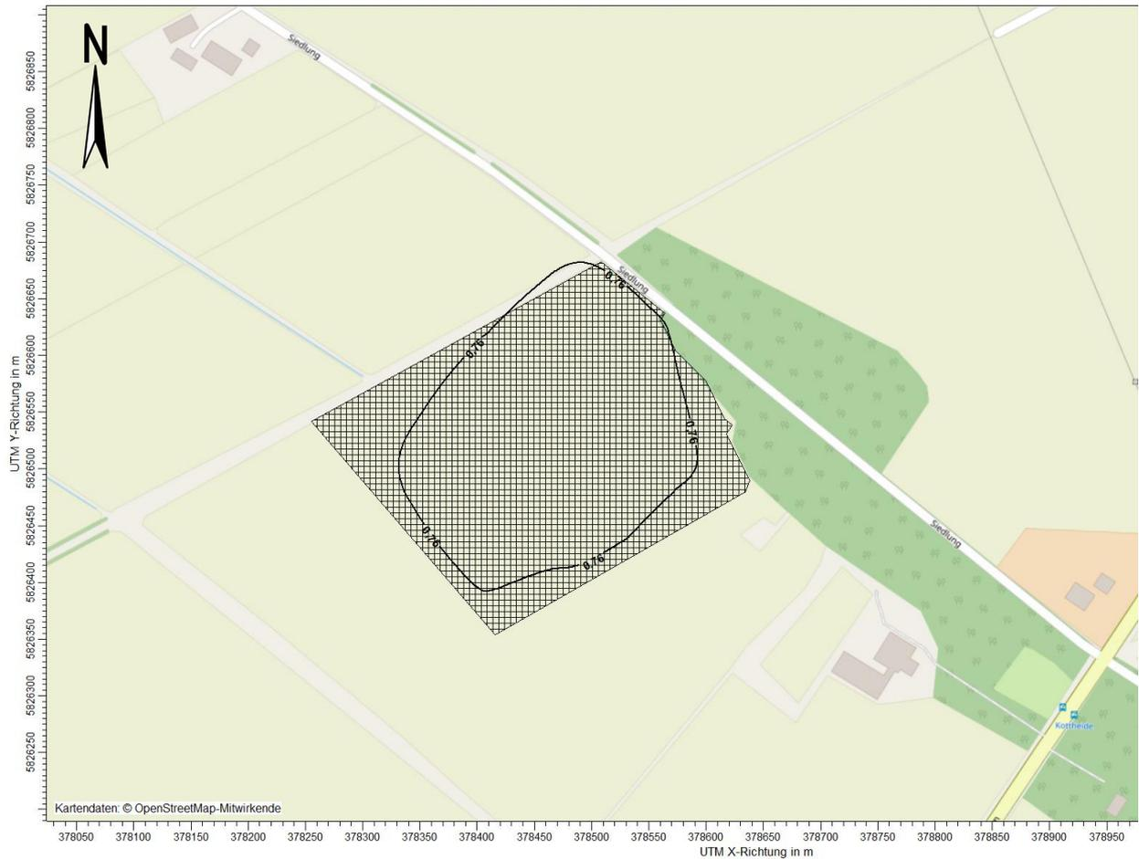
Abbildung 10: Schwebstaub (PM-2,5): Gesamtzusatzbelastung durch die Anlage Topphoff im geplanten Zustand in  $\mu\text{g}/\text{m}^3$
