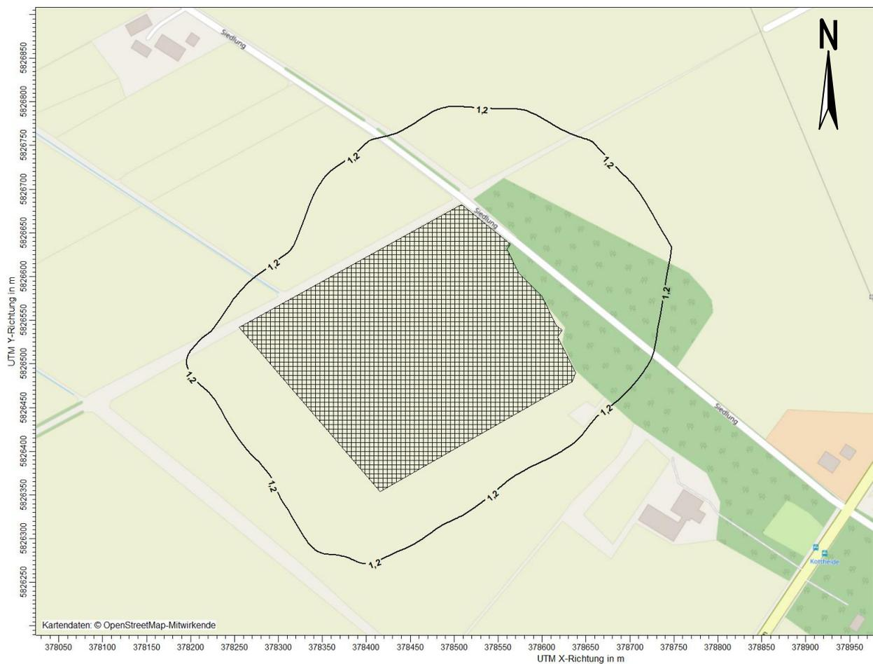
Abbildung 8: Schwebstaub (PM-10): Gesamtzusatzbelastung durch den geplanten Legehennenstall in  $\mu\text{g}/\text{m}^3$
