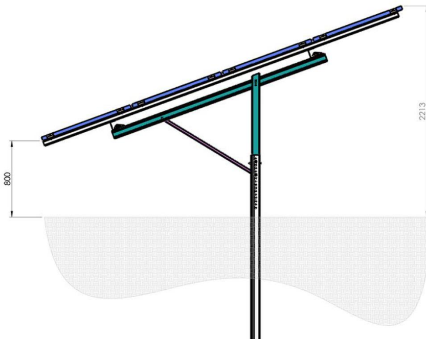
Abbildung 8: Prinzip-Skizze zur Aufständering der Solarmodule
