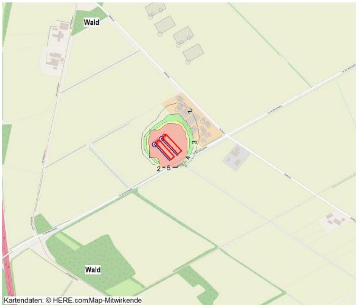
Abbildung 10: Ausschnitt aus der Anlage 6.2 „Gesamtzusatzbelastung an Stickstoffdeposition“ (FIDES 2023)
